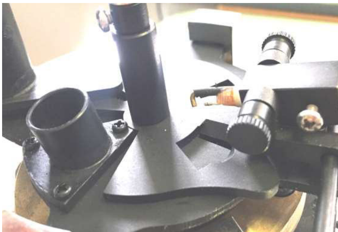
Рис. 6. Установка электрического воспламенителя в рабочее положение
